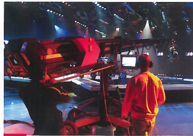
Het balanceergewicht (rode element) van de Xtreme T12 telescopische camera-arm beweegt heen en weer bij het in- en uitschuiven van de arm. De pijlvorm maakt die dynamiek zichtbaar. (Egripment Support Systems).
