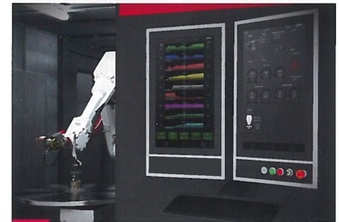
In de grafische interface van deze machine voor thermisch spuiten van deklagen zijn afbeeldingen toegepast die in een oogopslag de status weergeven van bijvoorbeeld gas- en poedervoorraad. (Oerlikon Metco)
